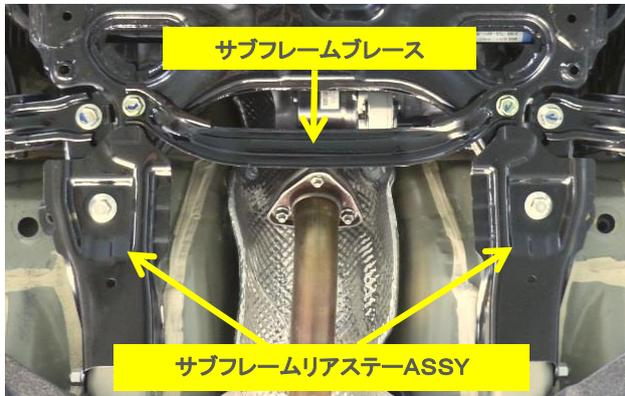
③STIFF PLATE及び純正サブフレームブレースを付属のボルトA、Bを使用し下画像のように取り付けます。
