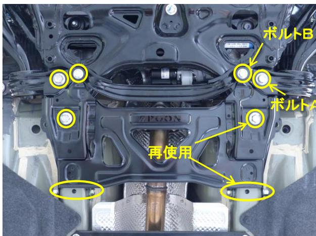
※サブフレームブレースは下図のように、STIFF PLATEと共締めします。
